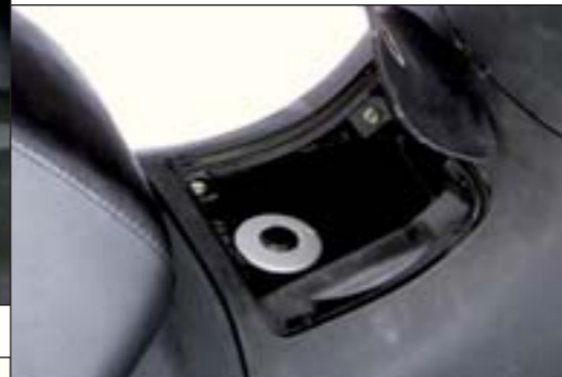
La ubicación del tapón y depósito de gasolina es en el túnel central.
